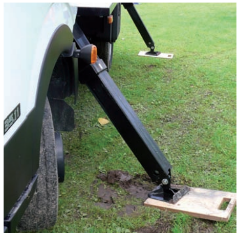
Bild 4-4: Gute (hinten) und schlechte (vorne) Abstützung
