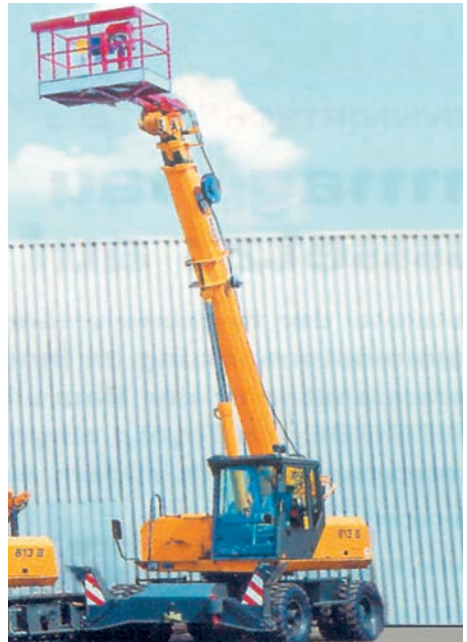
Bild 3-9: Kran mit Arbeitskorb
