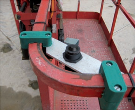
Bild 6-5: Absicherung von Bedienpult und Geländer durch Sensortechnik
