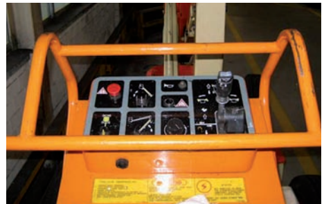
Bild 6-3: Schutzbügel gegen unbeabsichtigtes Betätigen der Bedienelemente
